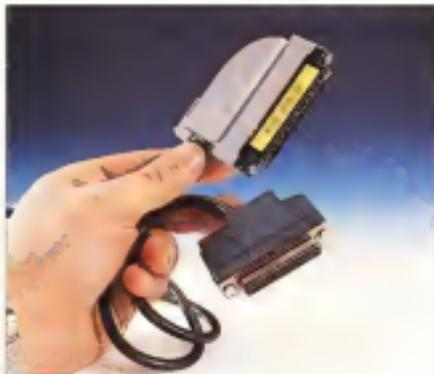
Due particolari della costruzione dei modem: a sinistra il pannello posteriore in cui si nota il pratico sistema di connessione che gli offre il contatto a pressione per il diffusore acustico. A destra i connettori: quello sopra per il C&M e quello sotto per l'IBM
